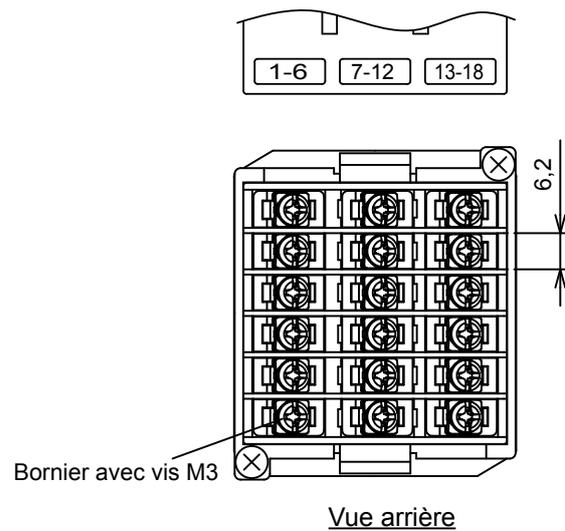
Le bornier n'est pas relié aux bornes non utilisées (bornes 7 à 12) selon ce modèle.
