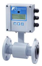
Le tube de mesure type VI est disponible avec différents type de brides de raccordement procédé (DIN, norme ANSI, JIS, AWWA, etc.) et de revêtements intérieurs comme le caoutchouc dur ou le PTFE. Disponible pour des diamètres de DN 15 à DN 600 et pour des pressions nominales jusqu'à PN 100, le tube de mesure type VI est le meilleur choix pour une grande variété d'applications de comptage dans l'industrie de l'eau.
