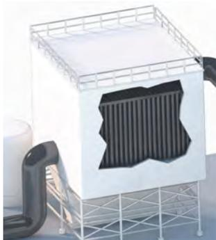
Contrôle de rupture de filtre à manche
