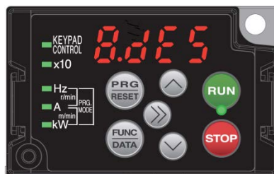
Figure 4.3-1 Affichage de l'écran LED après la mise sous tension
