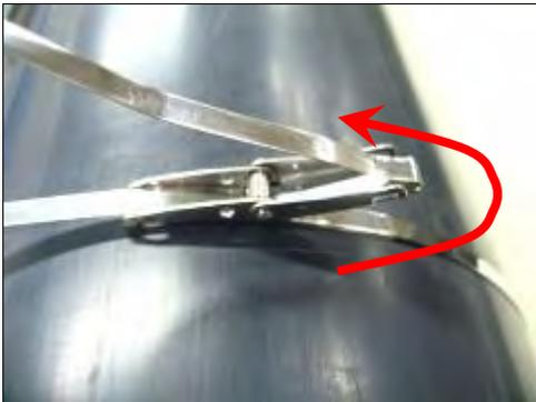
1-4) Fermer le loquet en tordant le collier une seconde fois au fond du système de verrouillage.
