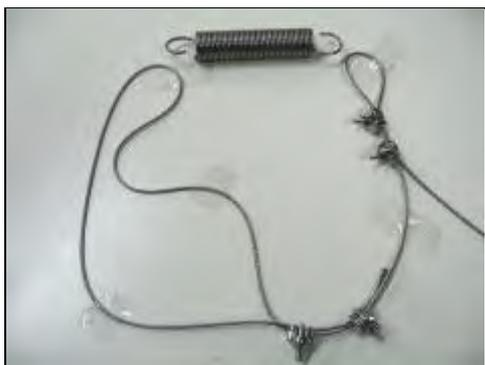
4-2) Encadrer le capteur en plaçant la boucle à chaque extrémité du rail, enrouler le câble autour de la conduite et relier les deux boucles par le ressort. La longueur du ressort tendu est d'environ 180mm.
