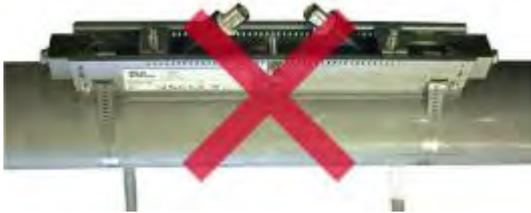
Ne montez pas les connecteurs BNC des capteurs en les pointant vers l'intérieur.
