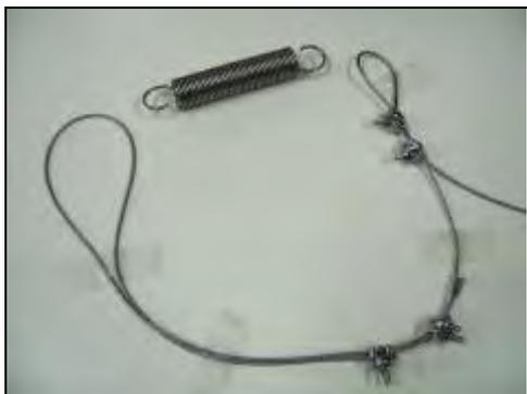
4-2) Placer la boucle du câble dans le trou à l'extrémité du capteur, enrouler le câble autour de la conduite et relier les deux boucles par le ressort. La longueur du ressort tendu est d'environ 180mm.
