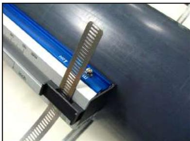
3-2) Faites passer la courroie à l'intérieur de la patte de fixation.
