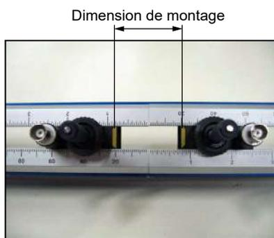
(4) Appliquez le coupleur acoustique sur la surface de transmission du capteur.
