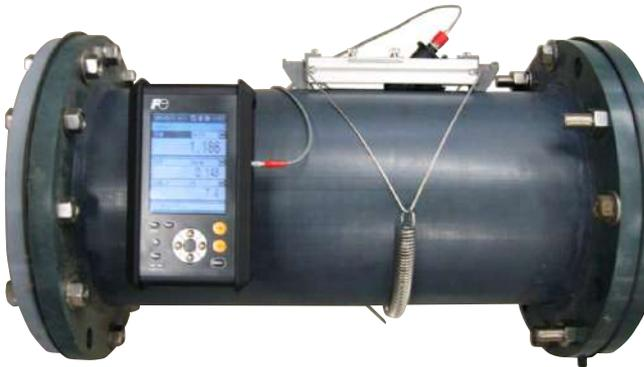
Pour une mesure bidirectionnelle, raccordez-les côté amont et côté aval.
