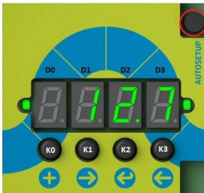
Figure 27: Interface principale du dispositif avec AUTOSETUP mis en évidence
