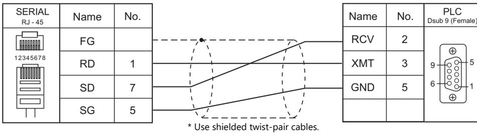
**Wiring diagram 4 - M2**
