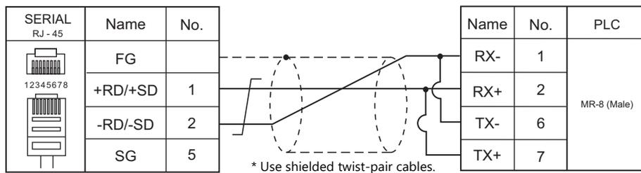
**Wiring diagram 4 - M4**
