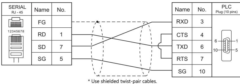
**Wiring diagram 5 - M2**
