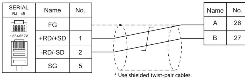
**Wiring diagram 4 - M4**
