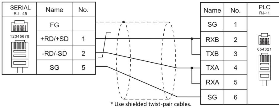
**Wiring diagram 4 - M4**
