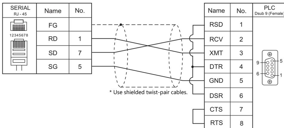
**Wiring diagram 5 - M2**
