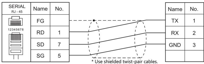
**Wiring diagram 6 - M2**
