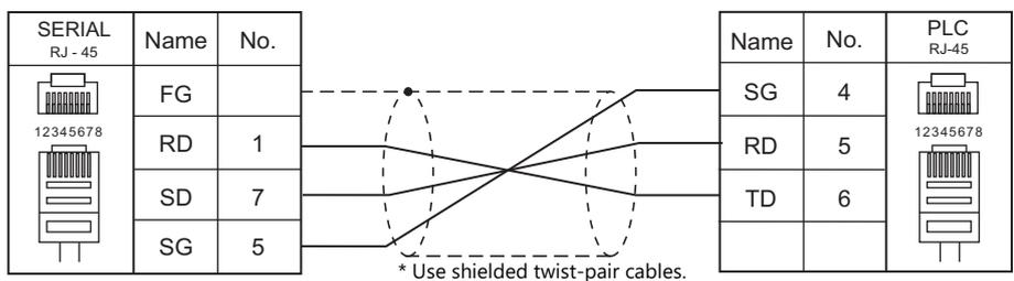
**Wiring diagram 5 - M2**
