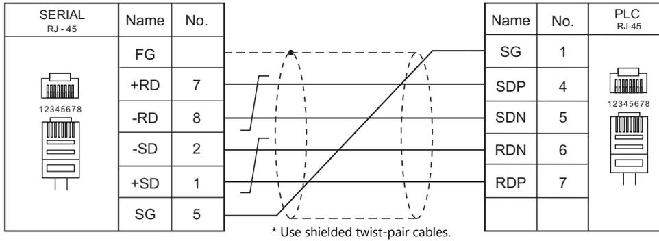
**Wiring diagram 11 - M4**
