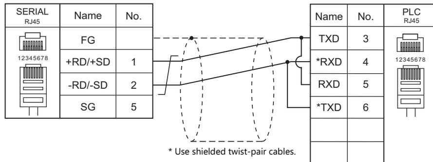
**Wiring diagram 18 - M4**
