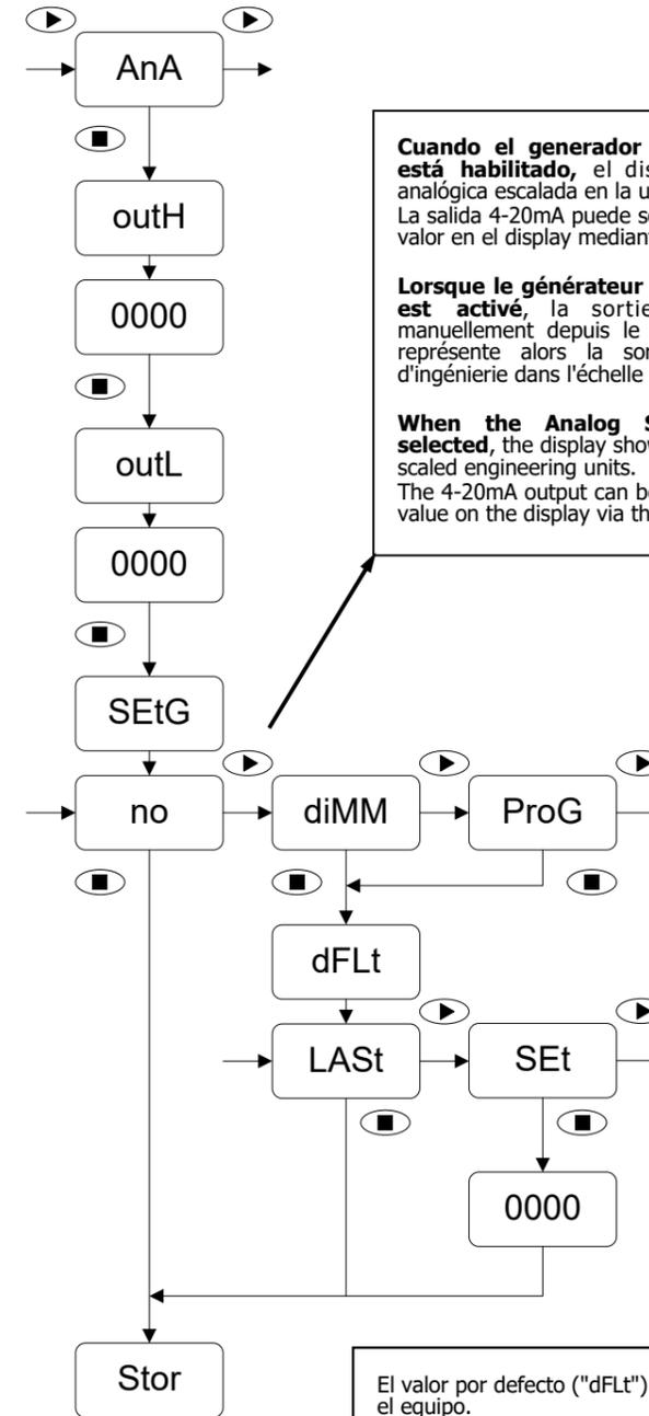
**Cuando el generador de consigna analógico está habilitado**, el display muestra la salida analógica escalada en la unidad de ingeniería. La salida 4-20mA puede ser modificada cambiando el valor en el display mediante el teclado frontal.
