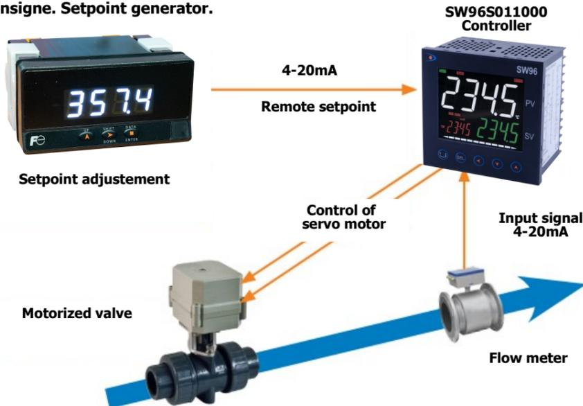
**Configuración de la salida analógica**
