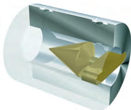
*Le Wafer-Cone® peut être monté entre deux brides pour une installation compacte. Il est disponible dans une grande variété de matériaux et le cône peut être facilement remplacé pour s'adapter aux conditions d'écoulement extrêmes.*
