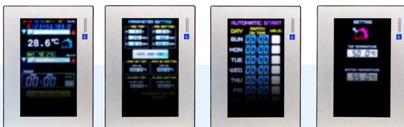
Le régulateur de température PID modulaires multi-boucles, permet aussi de contrôler et réguler plusieurs zones en même temps. L'utilisateur sera donc capable de régler la température de la sole et la température de la voûte de son four à pizza séparément, de manière précise et efficace. La conception modulaire des régulateurs propose une solution flexible pour la régulation de température quel que soit les dimensions du four à pizza.
