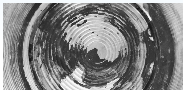
Membrane d'un séparateur en acier inoxydable austénitique qualité urée 1.4466
