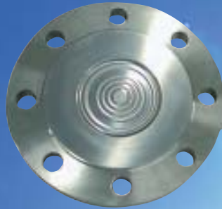
Mesure de pression différentielle (Chimie), insert PVDF et membranes dorées pour service hydrogène ou fluides fortement corrosifs
