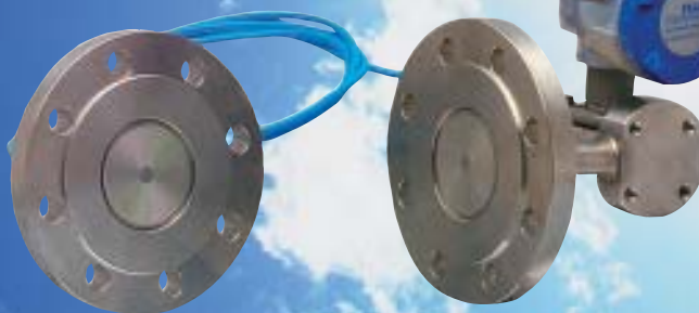
Mesure de niveau sur cuve fermée, séparateurs DN80 / PN40 à capillaire côté BP et rigide côté HP
